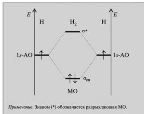
Рис. 15.3. Диаграмма энергетических уровней молекулы водорода по методу ЛКАО МО
